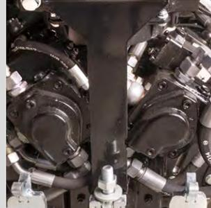
**Leistungsstarker Hydraulikantrieb** der Raupenlaufwerke mit **Dual Axialkolbenpumpen**. Je Raupenantrieb eine leistungsstarke Axialkolbenpumpe und ein Radmotor als geschlossener Kreislauf mit effizienter Leistungsübertragung.
