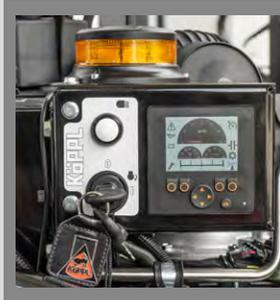
**Übersichtliches Display** mit grafischer und digitaler Anzeige der Maschinenparameter und des Gerätestatus. Klare Menüführung und Diagnosefunktionen durch integrierten Fehlerspeicher. Tankfüllstandsanzeige an Display und an der Funkfernbedienung.
