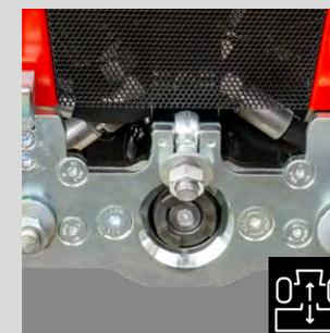
**Schnellwechselflansch** mit Fankhaken für müheloses und zügiges Auswechseln der Anbaugeräte
