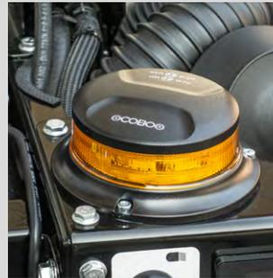
**Blitzleuchte** zur Anzeige des Betriebs serienmäßig. Die Stroboskop-Blitzleuchte sorgt für Sichtbarkeit und Arbeitssicherheit im Betrieb.
