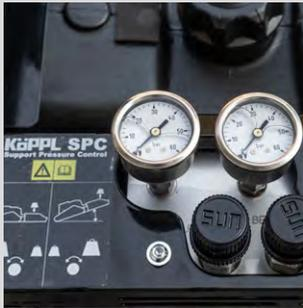
**KÖPPL SUPPORT PRESSURE CONTROL (SPC)** garantiert immer den richtigen Auflagedruck des Anbaugeräts abhängig von der Hangneigung.
