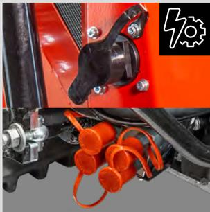
**Elektrischer Anbaugeräte-Anschluss** zur Steuerung elektrischer Anbaugeräte-Funktionen.
