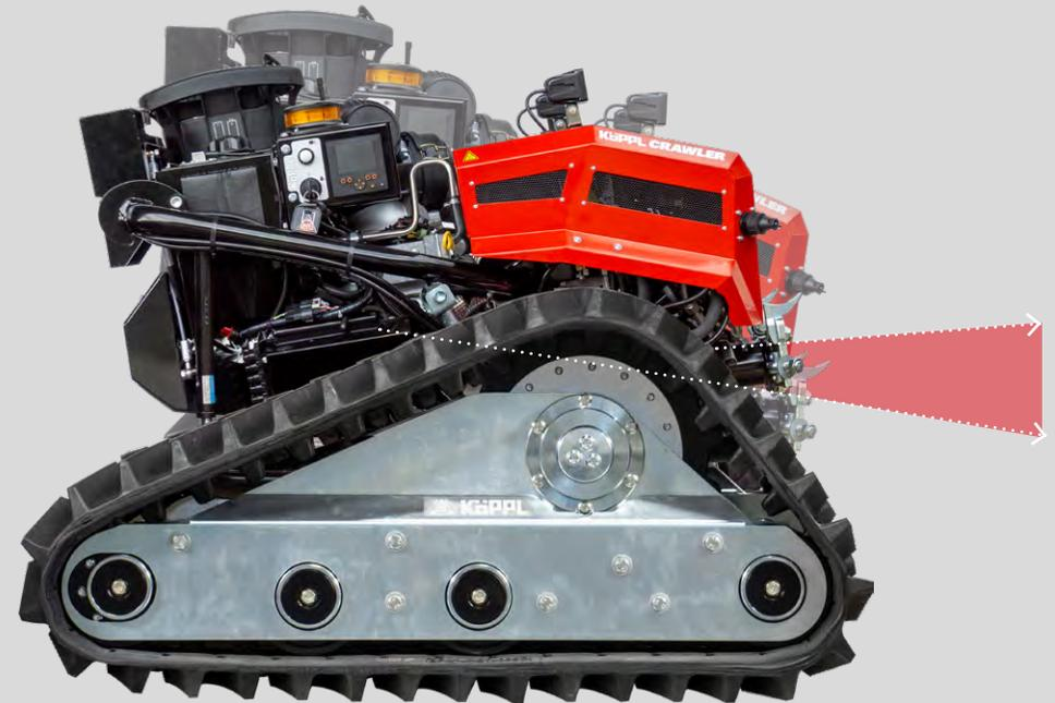
Der funkgesteuerte KÖPPL CRAWLER ist mit einer speziellen Hubeinrichtung ausgestattet, die den gesamten Korpus inklusive Anbaugerät anheben kann. Das unterstützt den schnellen und einfachen Wechsel der Anbaugeräte. Anschlüsse zur hydraulischen oder elektrischen Anbaugerätesteuerung mit Schnellkupplung sind leicht zugänglich.
