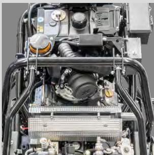
**Leistungsstarker Motor mit elektronischer Einspritzung (EFI), effektivem Zyklon-Luftfilter und Temperaturüberwachung.** Motorleistung und hydrostatischer Antrieb von KÖPPL optimiert und abgestimmt für ein optimales Einsatz-Leistungsprofil.
